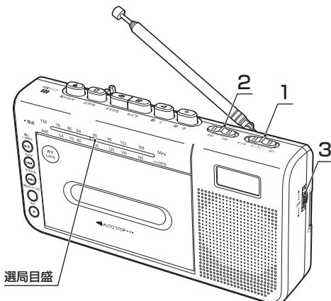
音量を調節する 「音量」ダイヤルを回す。
