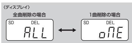
7. SDカード操作部の「再生モード/DEL」ボタンを長押しする。
