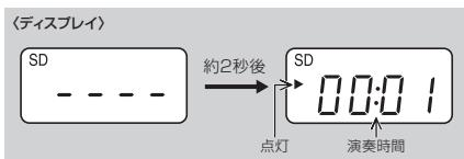
4. 本機で録音したMP3ファイルを聴く場合は、SDカード操作部の「聴く/一時停止(▶II)」ボタンを長押しする。
