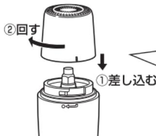
アタッチメントの □ 印と本体の ←→ 印を合わせ、アタッチメントの □ 印が本体の ○ 印に合うまで回す。
