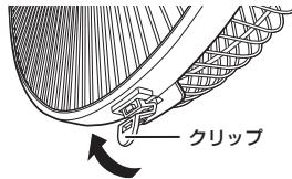
②上部を支え、クリップの下のつまみを持ち、前ガードの下部を引きはずします。
