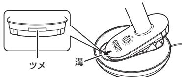
⑤電源コードの保護チューブ部分をベースの溝に通し、底面からベース固定ネジを取り付けます。
