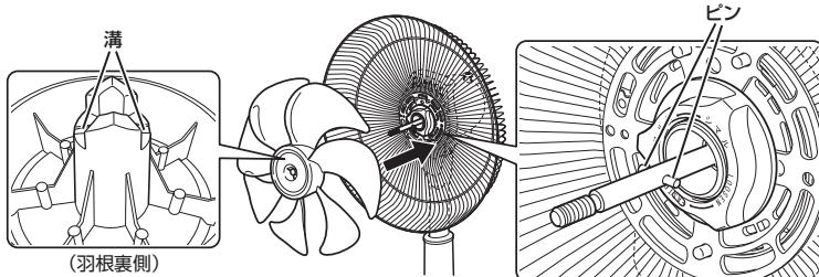
②スピナーナーを反時計回りに回して締め付けます。
