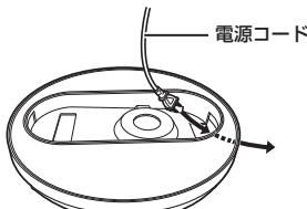
④電源コードを引き出しながら、本体後方のツメとベース後方の溝が合うようにはめ込みます。
