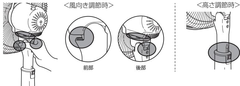
●組み立て時、電源コードを必ずベースの穴に通し、保護チューブ部分をベース溝に通す。
