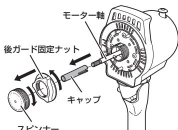
②後ガードの丸穴を、モーター部の凸部(3箇所)に合わせて差し込みます。
