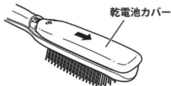
2 乾電池ケースの内側の表示に合わせて乾電池を入れ、乾電池カバーをスライドさせてはめます。
