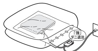
4. コントローラーの温度調節目盛を「強(ダニ退治)」の位置にし、約3時間通電する。
