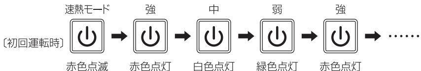
※運転開始後、2時間経過すると自動的に運転が停止します。(2時間自動OFFタイマー)
