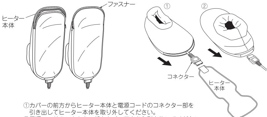
①カバーの前方からヒーター本体と電源コードのコネクター部を引き出してヒーター本体を取り外してください。
