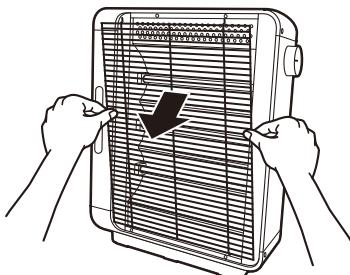
2 ガードの上方を手前に引き出して斜めに引き上げる。
