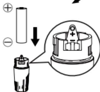
**3** 電池キャップを矢印の方向に回して取り付けます。
